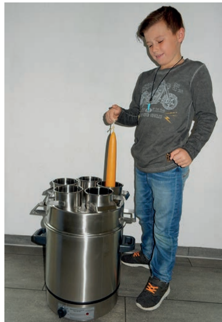
Ein neues Wachsschmelzgerät mit integrierter Heizplatte.
